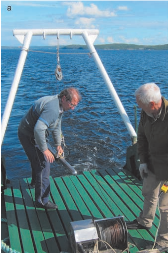
Рис. 10.3.3. Сонар СМ-2 (С-МАХ, Великобритания): а – подготовка буксируемого устройства (антенны) к работе, б – фрагмент сонограммы поверхности дна с затопленным судном (длина 120 м, ширина 20 м, максимальная высота над дном – 15 м)
