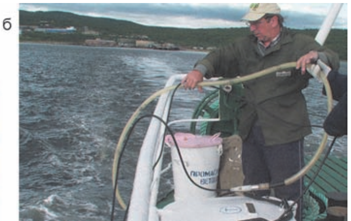
Рис. 10.3.4. Сейсмоакустический комплекс GEONT–HRP: а – цифровой блок управления и регистрации записи НСП, б – спуск приемной сейсмокосы
