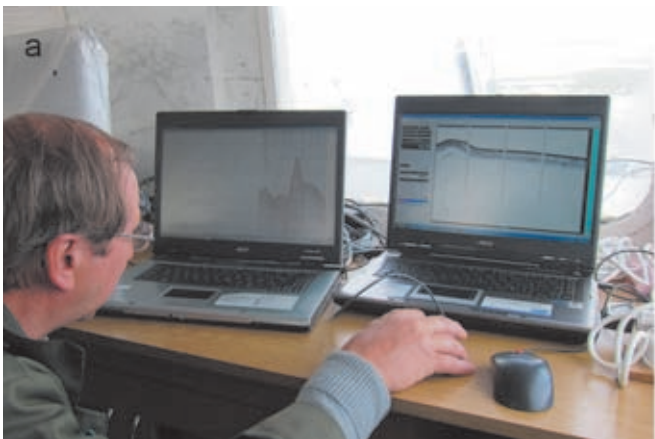
Рис. 10.3.4. Сейсмоакустический комплекс GEONT–HRP: а – цифровой блок управления и регистрации записи НСП, б – спуск приемной сейсмокосы
