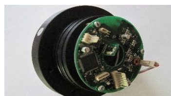
Рис. 2. Фотография измерительных блоков – вид со стороны аналого-цифрового модуля с БО и БОП.
