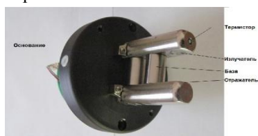
Рис. 1. Фотография измерительных блоков – вид со стороны датчиков глубины, температуры и скорости звука в воде.
