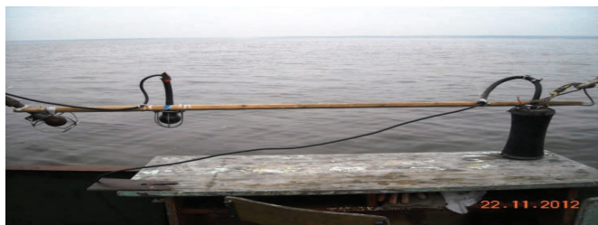
Рис. 3. Компактный НЧИ продольно-изгибного типа с пьезоэлектрическим активным элементом.
