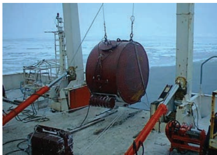
Рис. 1. НЧИ с электромагнитным преобразователем, разработанный ИПФ РАН для акустической термометрии океанского климата [4].
