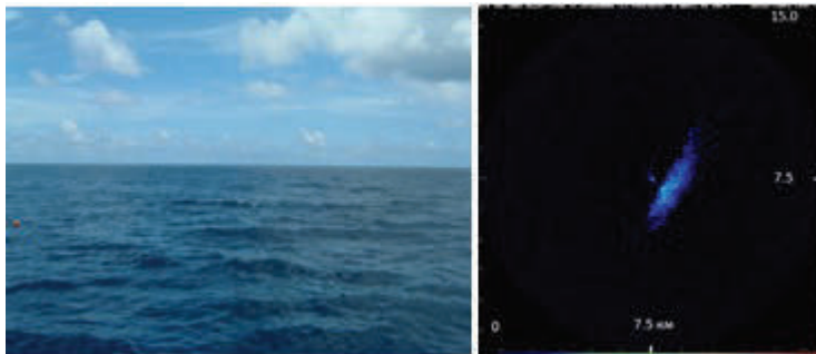
Рис. 2. Вид поверхности моря в момент прохождения внутренней волны (слева) и его радиолокационное изображение (справа).
