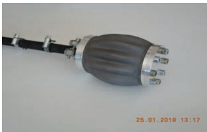
Рис. 4. НЧИ продольно-изгибного типа с излучающей оболочкой сложной формы («3D НЧИ»).
