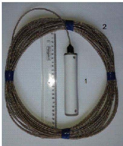
Рис. 1. Автономный измеритель внутренних волн (записывающее устройство – 1, распределенный датчик температуры РДТ длиной 20 м – 2).
