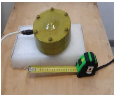
Рис. 5. НЧИ инерционно-изгибного типа с пьезоэлементом.
