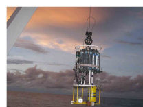
Комплекс погружаемых приборов CTD/LADCP
